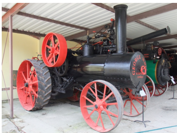
Lokomobila parowa do napędu maszyn młócących (Garret Smith & Co, Magdeburg, Niemcy, 1895)
