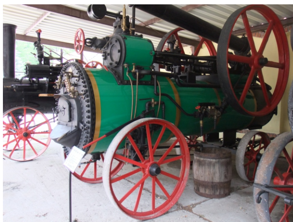
Samobieżna lokomobila parowa do prac polowych i transportowych (Gorge White & Sons Co Limited, Kanada, 1910)
