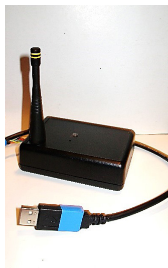
Fot. 2. Czujnik i antena zbiorcza przekazująca dane do komputera (fot. E. Kuźnicka, 2017) Photo 2. Sensor and collecting antenna transmitting data to a computer (phot. E. Kuźnicka, 2017)
