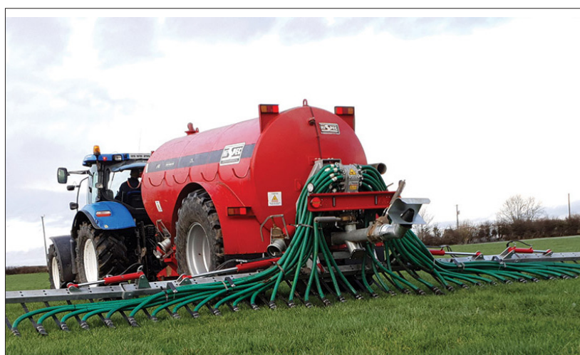
Fot. 2. Aplikacja płynnych nawozów naturalnych wykorzystująca tzw. węże wleczone Photo 2. Liquid fertilizer application using so-called trailing hoses ( https://www.fwi.co.uk/machinery/spraying-and-fertilising/slurry-tankers/hi-spec-unveils-new-trailing-shoe-slurry-applicator )
