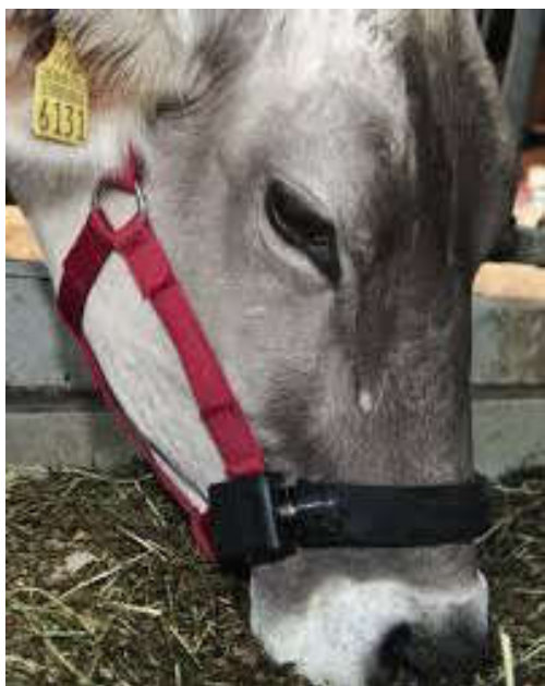
Fot. 1. Sensor nosowy NBS systemu RumiWatch (ITIN-HOCH)
