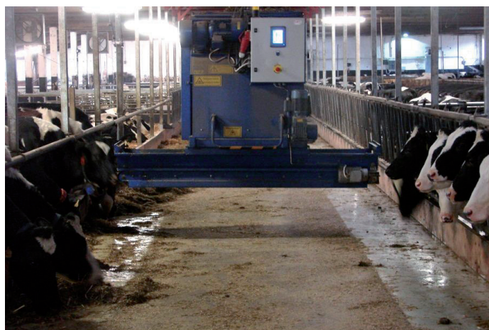
Fot. 8. Wózek paszowy podwieszany na szynie nad stołem paszowym o szerokości około 3,5 m w zmodernizowanym jałowniku (fot. A. Kaczor)
