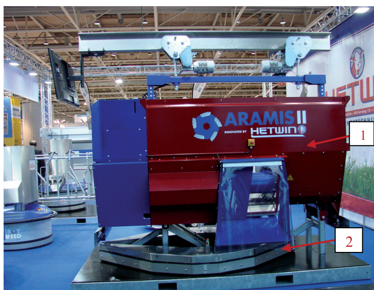
Fot. 3. Wózek paszowy podwieszany na szynie do transportu i zadawania paszy TMR z funkcją mieszalnika: 1 – wózek paszowy, 2 – podgarniacz (fot. A. Kaczor)
