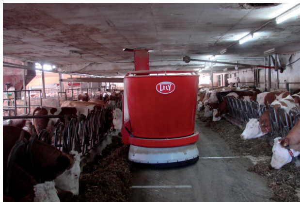
Fot. 4. Samojezdny wózek paszowy do mieszania i zadawania paszy w zmodernizowanej oborze (fot. A. Kaczor)
