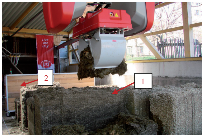
Fot. 6. Kuchnia paszowa wyposażona w dźwig z suwnicą do pobierania kiszonki z bloków i załadunku wózka: 1 – bloki kiszonki, 2 – zasobnik na rozdrobnioną słomę (fot. A. Kaczor)
