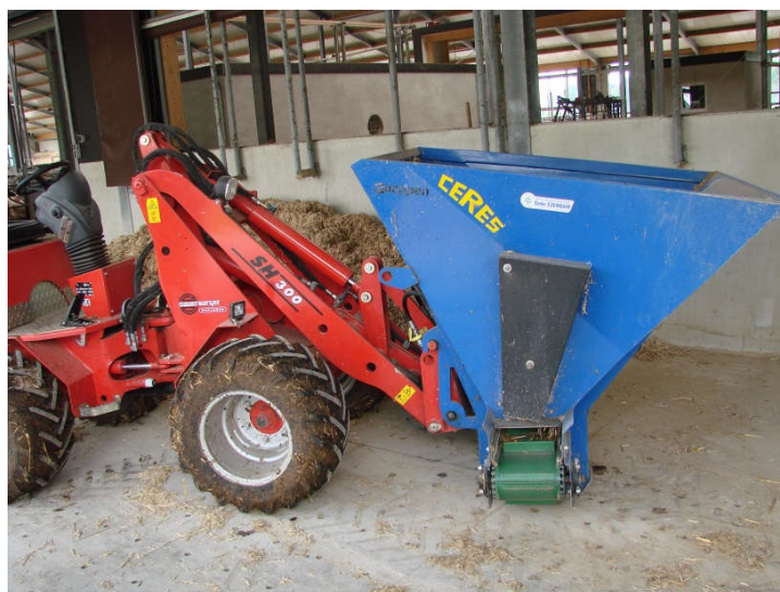
Fot. 5. Ścielarka do ścielenia boksów legowiskowych mieszaniną słomy, wapna i wody lub separatem Phot. 5. Straw dispenser for the bedding of lying boxes with a mixture of straw, lime and water or slurry solids
