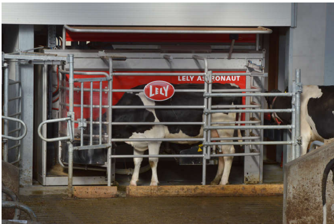
Krowa podczas doju w robocie Cow milked by a robotic milker
