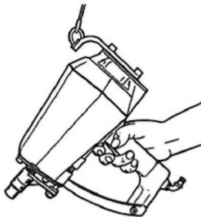
Rys. 1. Schemat aparatu pneumatycznego do oszałamiania zwierząt Fig. 1. Schematic of a pneumatic stunner (Olszewski, 2007)
