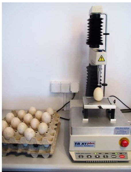
Fot. 1. Pomiar odkształcenia elastycznego skorupy – analizator tekstury TA.XT PLUS (Stable Micro Systems)
