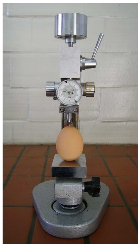
Fot. 3. Aparat firmy N.V. Marius-Utrecht (Holandia), wykorzystywany do manualnego pomiaru odkształcenia skorupy jaj przy stałym nacisku 500 g Photo 3. A N.V. Marius-Utrecht device (Holland) used for manual measurement of eggshell deformation at a constant pressure of 500 g (fot. E. Gornowicz)
