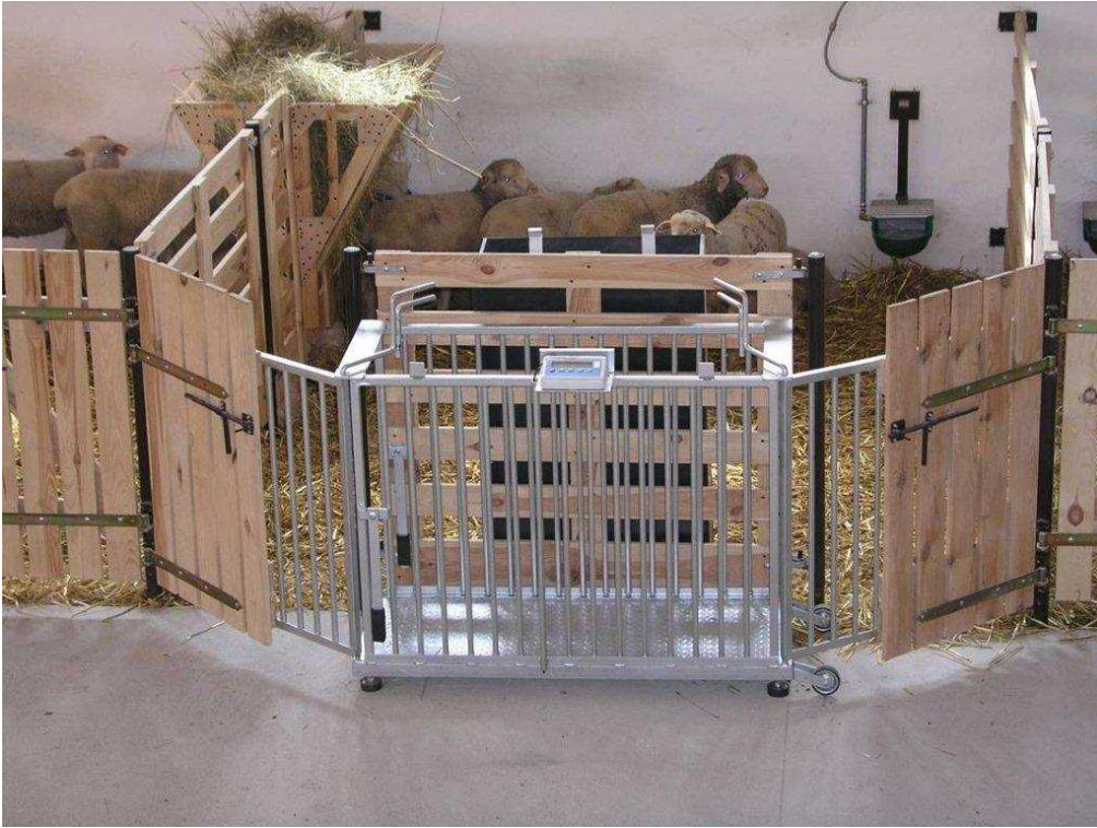
Przevoźna waga elektroniczna z czytnikiem i modulem do zapisu danych Mobile electronic scales with a data reader and logger (fot. J. Knapik)
