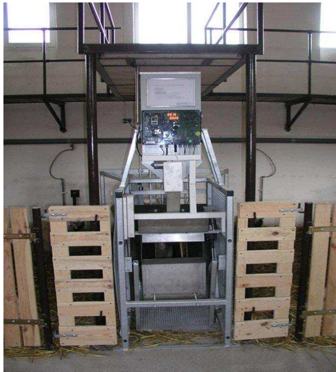
Sterowana komputerowo podwójna zgłoszeniowa stacja żywieniowa Computer-controlled double call feeding station (fot. J. Knapik)
