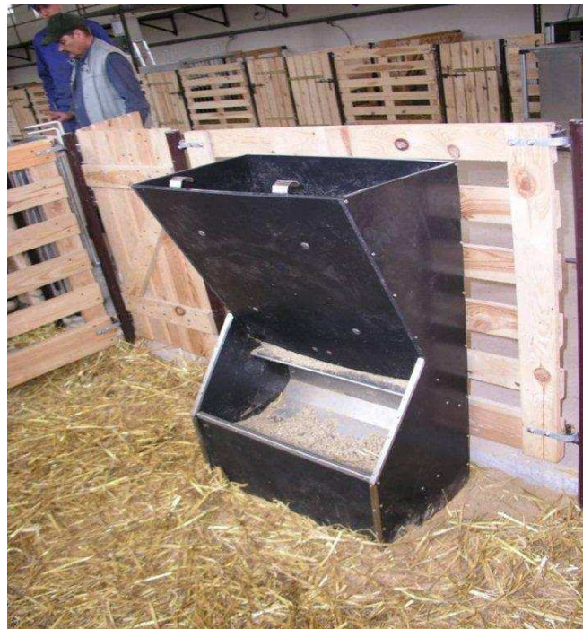
Dostosowane dla jagniąt samosypowe automaty paszowe Automatic feed hoppers adapted for lambs (fot. J. Knapik)
