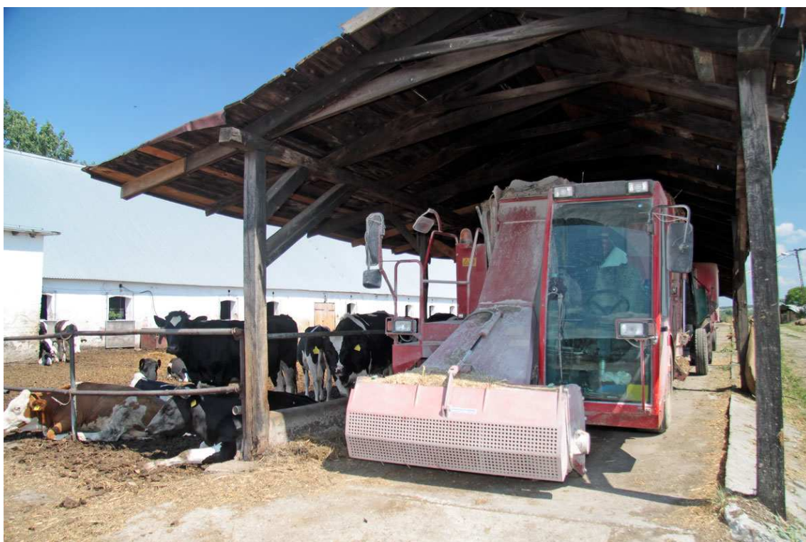
Samozjedny wóz paszowy Self-propelled feeder wagon (fot. R. Dąbrowski)
